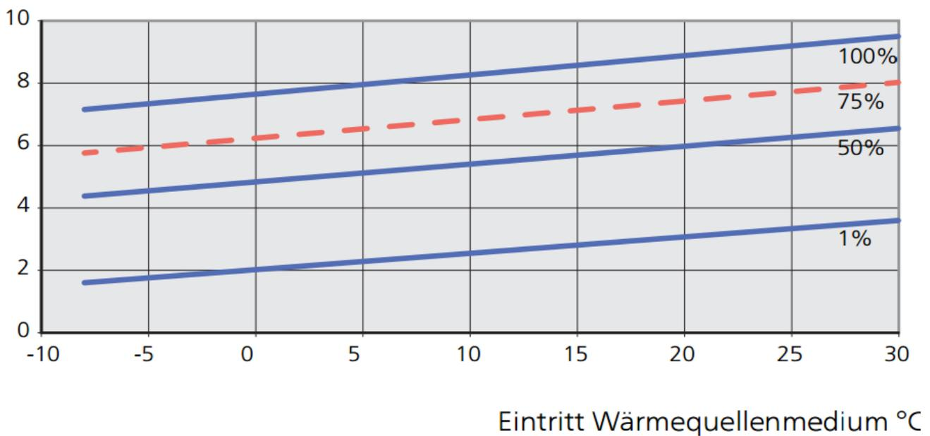
Der Prozentsatz zeigt die Verdichterdrehzahl an.
